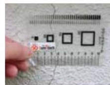
【クラックスケールによる外壁ひび割れ測定】
